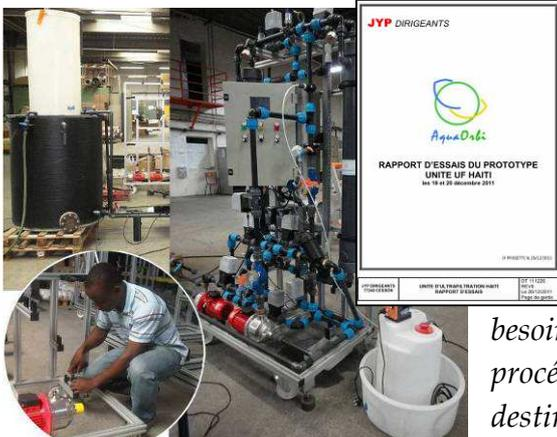
Le prototype de l'unité de traitement par ultrafiltration mis au point pour équiper les lacs collinaires en Haïti et, plus largement, les sites dépourvus de ressource en eau naturellement potable, a été testé dans les ateliers de notre partenaire Mégias, et réceptionné avec succès. Ce prototype, ou exemplaire n° 0, est destiné à rester en France pour servir d'unité test et de plateforme pour une télé-assistance si
